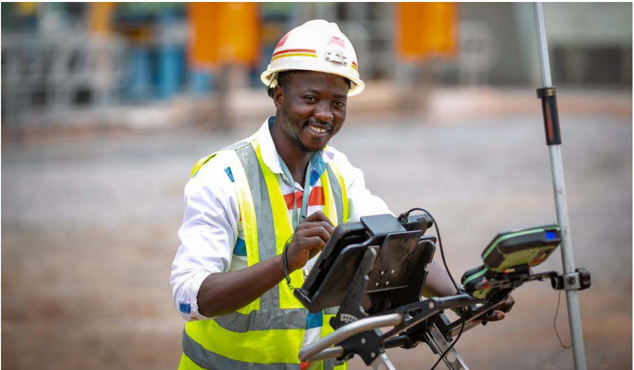
测量员 Lumbu Ghislain Pansemoya 使用探测雷达定位地下管道和电缆。
