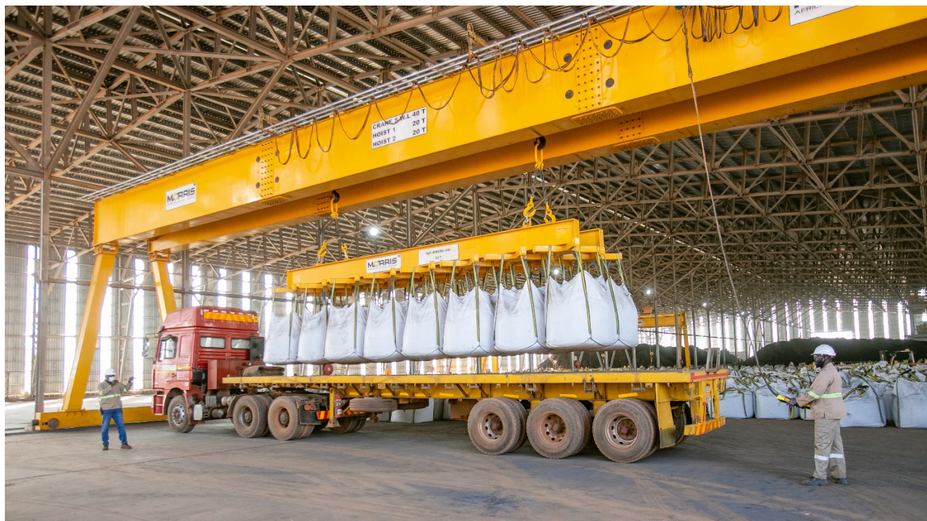
出口的袋装铜精矿正在被吊梁和起重机装载。
