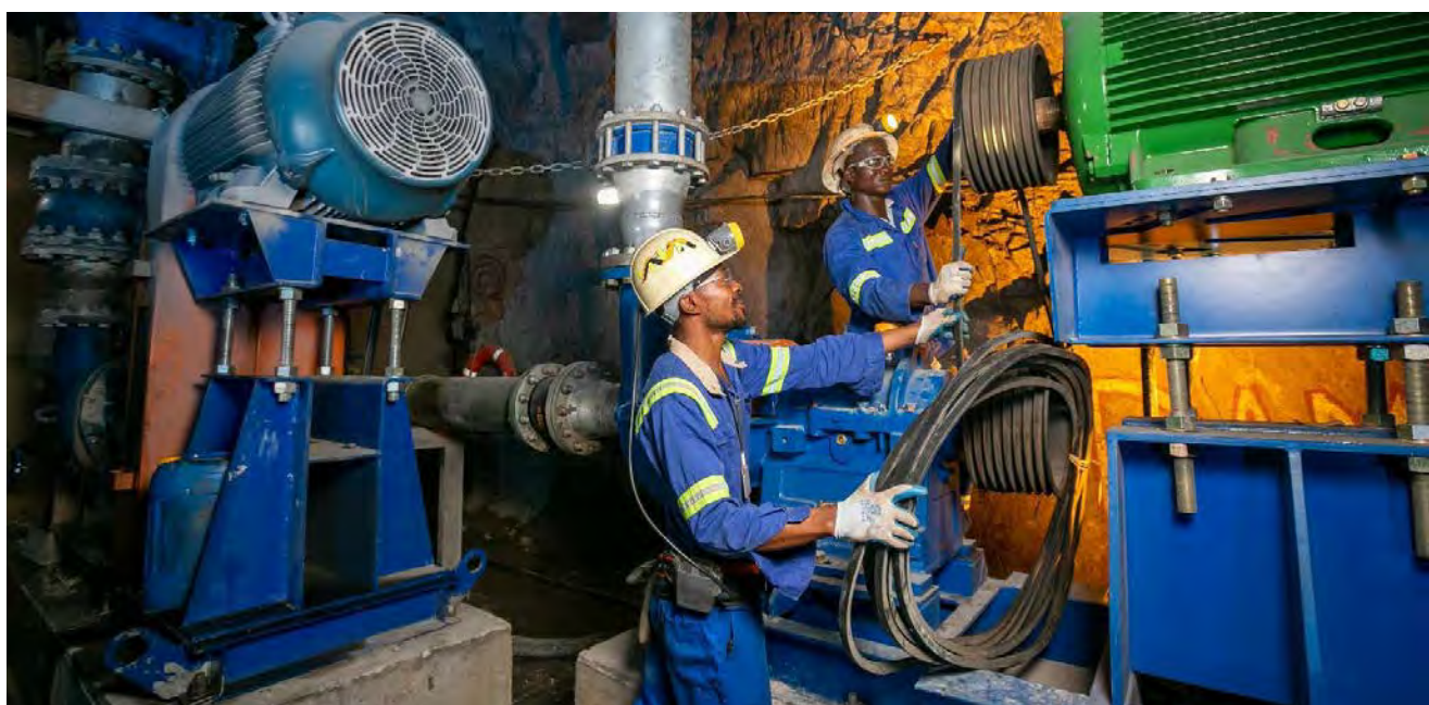
井下主管 Leandro Sanga (左) 和矿工 Mack Mwambu 在卡库拉矿山安装水泵传动带。
