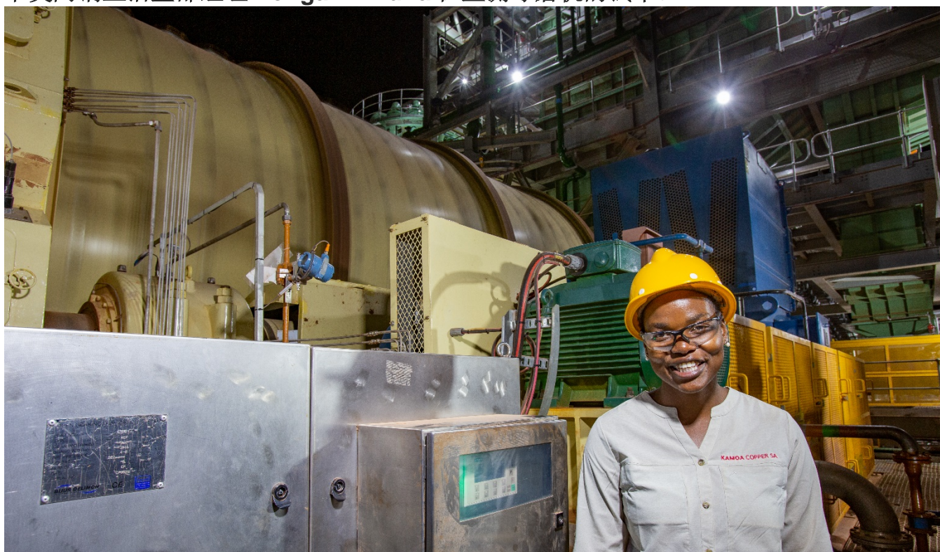
卡莫阿铜业冶金部经理 Vongani Nkuna 在监测球磨机的试车。
