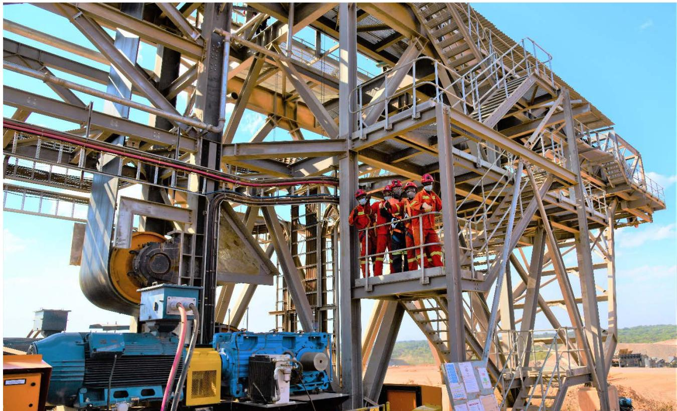
三号通风井的铰孔安装已经完工。现在位于一号通风井的一台高功率地表鼓风机将会移至三号通风井，而一号通风井将用作进风井(将新鲜空气抽进矿山)，三号通风井则用作出风井。四号通风井的铰孔安装预计于本月开始施工，并于7月底完工。
