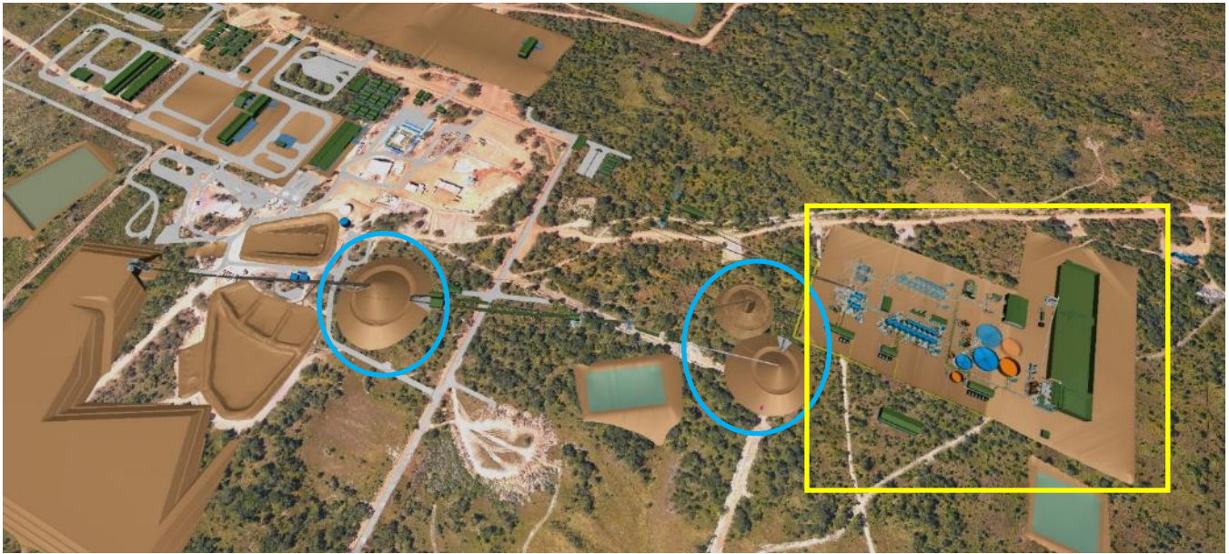
图3: Kakula的地表概念设计图, 显示了矿石储备 (蓝圈)和选矿厂 (黄框) 的位置。
