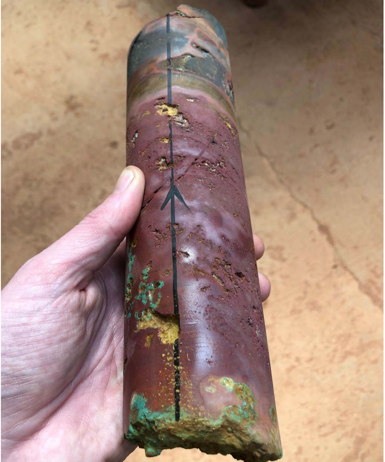
图 4 : DD1571 钻孔岩芯 (于 216 米深度处)显示了块状斑铜矿以及黄铜矿的痕迹。
