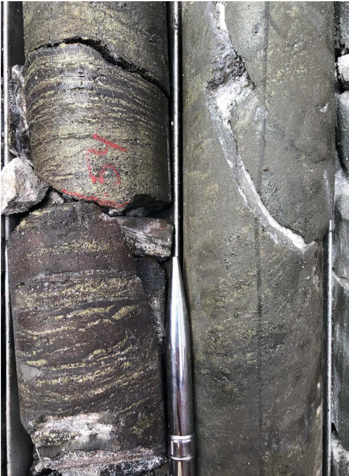
图 5 : DD1571 钻孔岩芯 (于 214 米深度处), 显示了在角砾岩矿带贯穿的浸染状辉铜矿 (含宽脉状的自然铜)。
