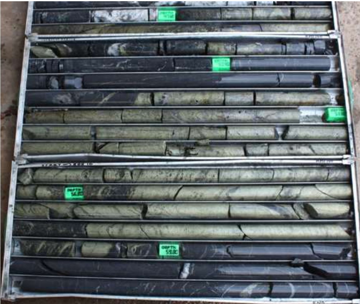
图 14：最近在 Kipushi 的 Série Récurrente 地带 KPU140 钻孔完成地下钻孔工程所得的高品位铜钻孔岩芯。
