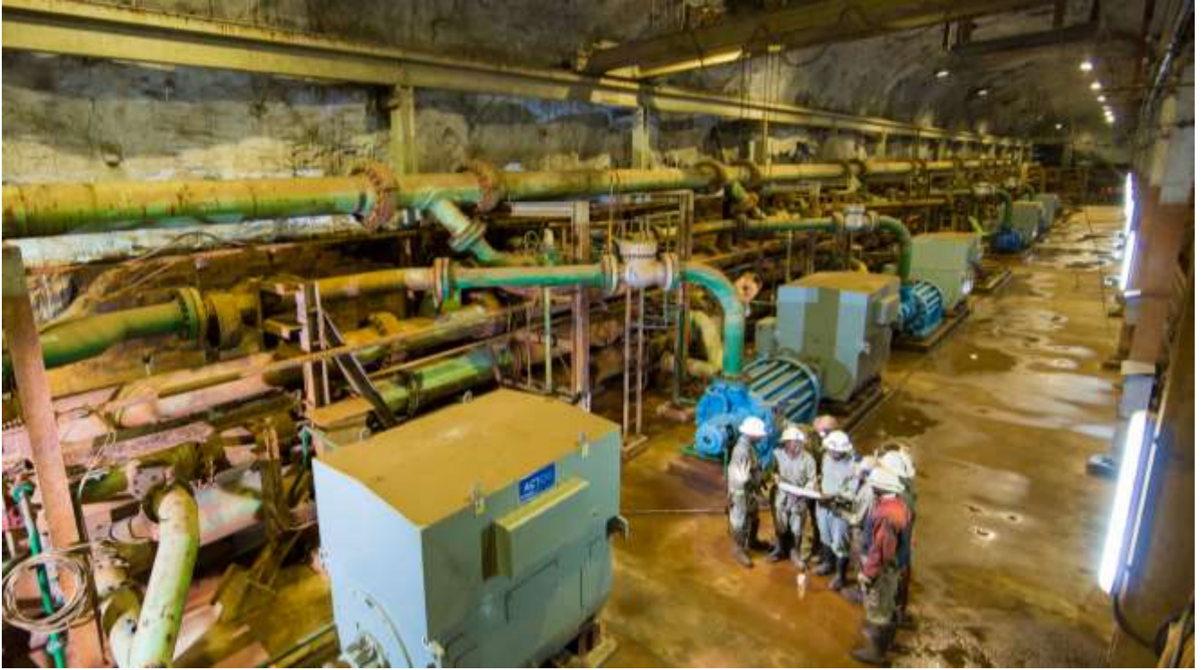
图4：五号矿井位于1,200米水平的主要水泵站。
