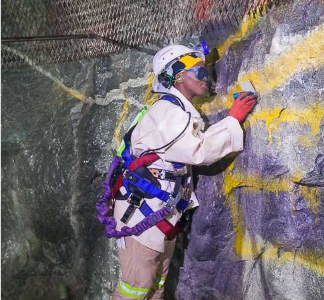
图 1: Platreef 工程师正在检查一号矿井壁的土力特性。
