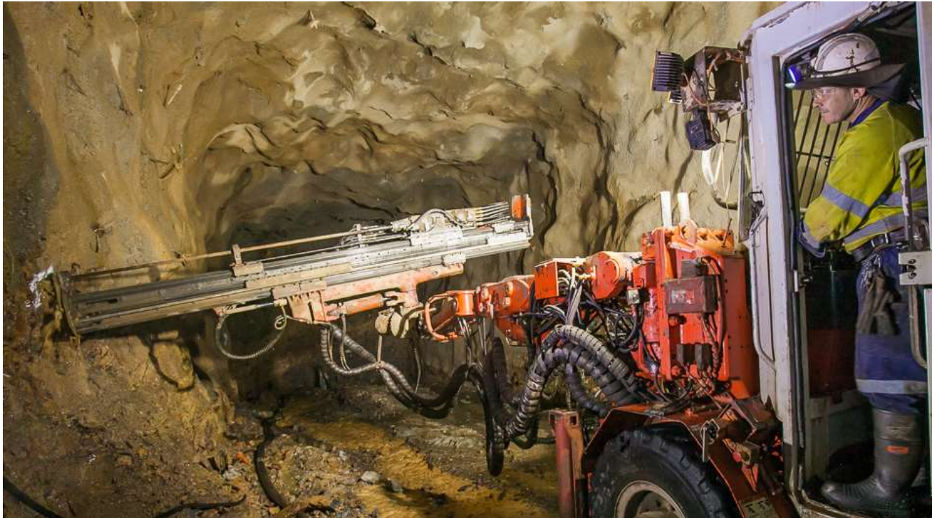
图 10： 在建设斜坡道期间操作地下钻探机。
