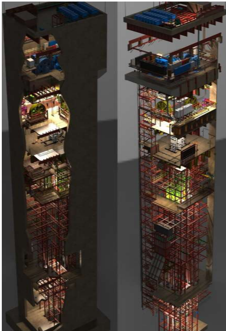
图 3： 下图以两个不同角度显示了二号矿井的 103 米高混凝土井架、地基和内部永久起吊设备。
