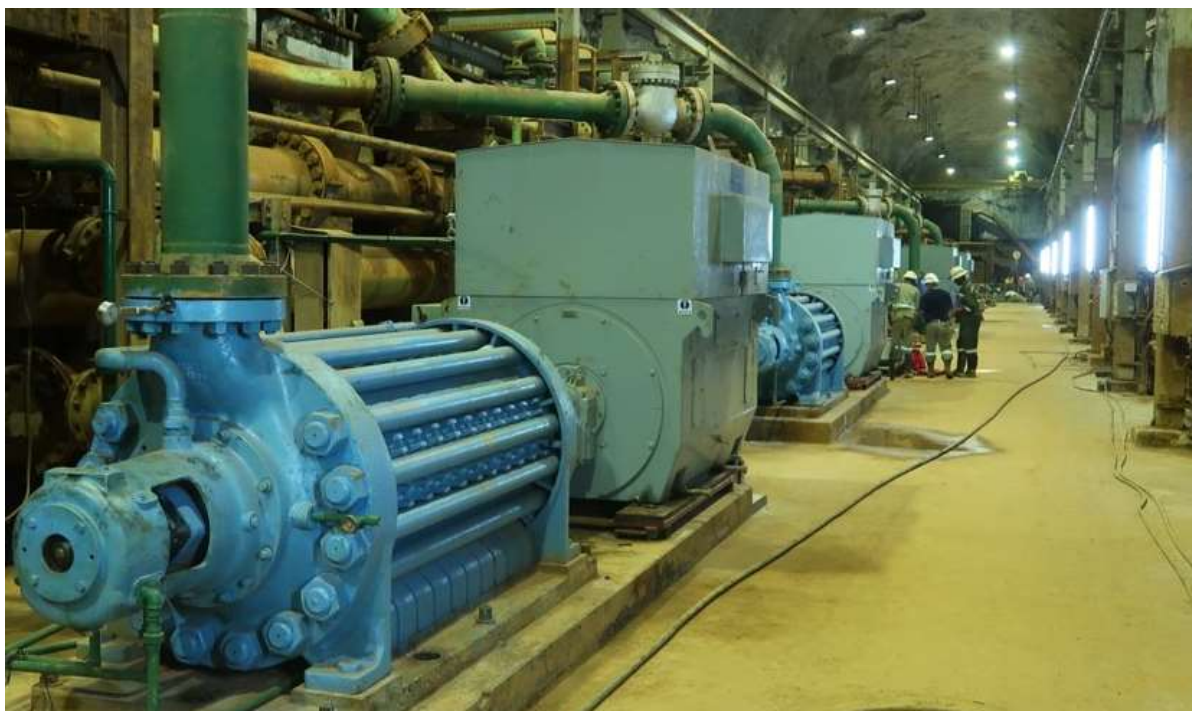
图4： Kipushi矿1,200米水平的高容量新水泵。
