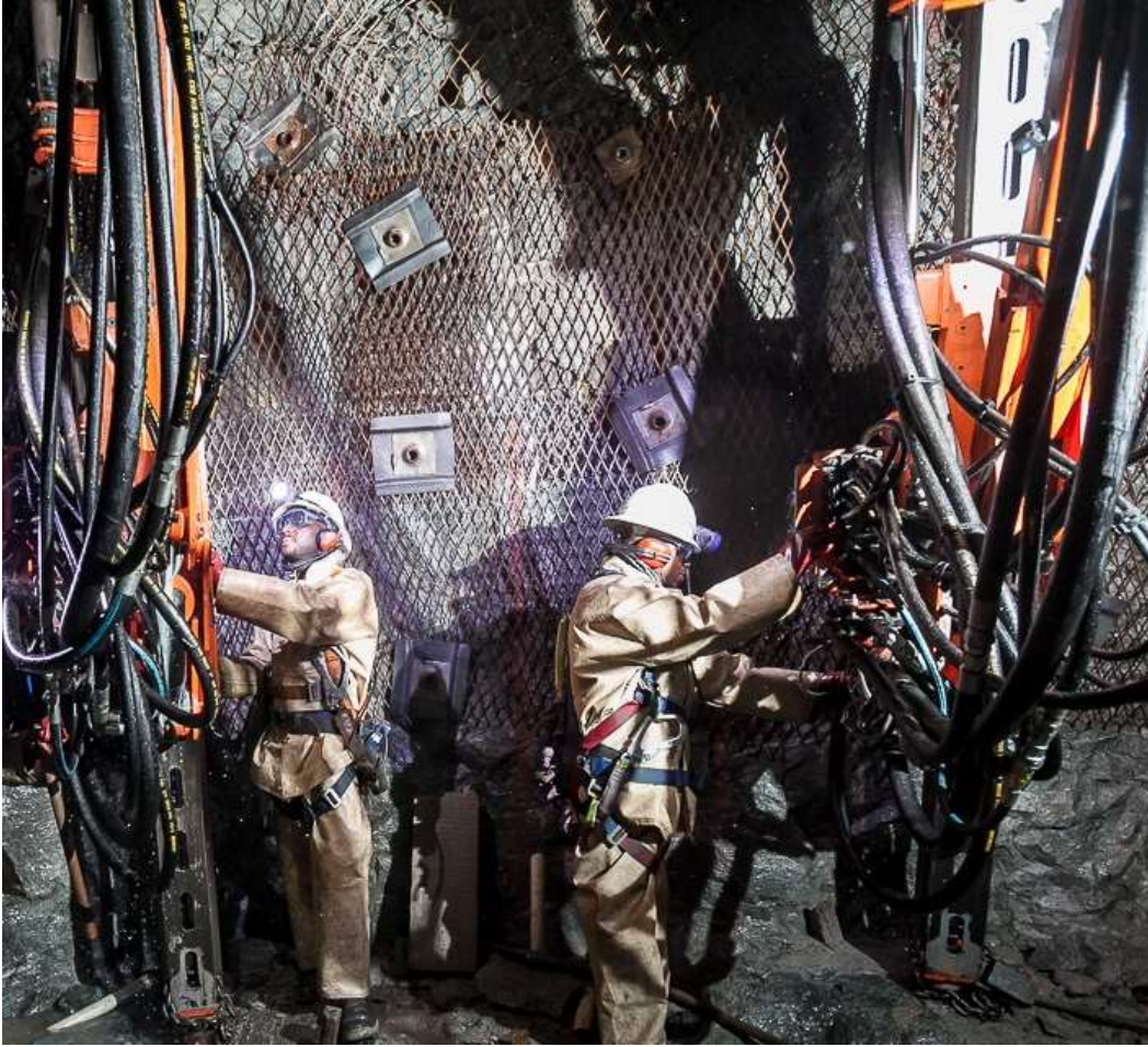
图 2：凿井工作人员在一号矿井地底操作大型的钻探机。
