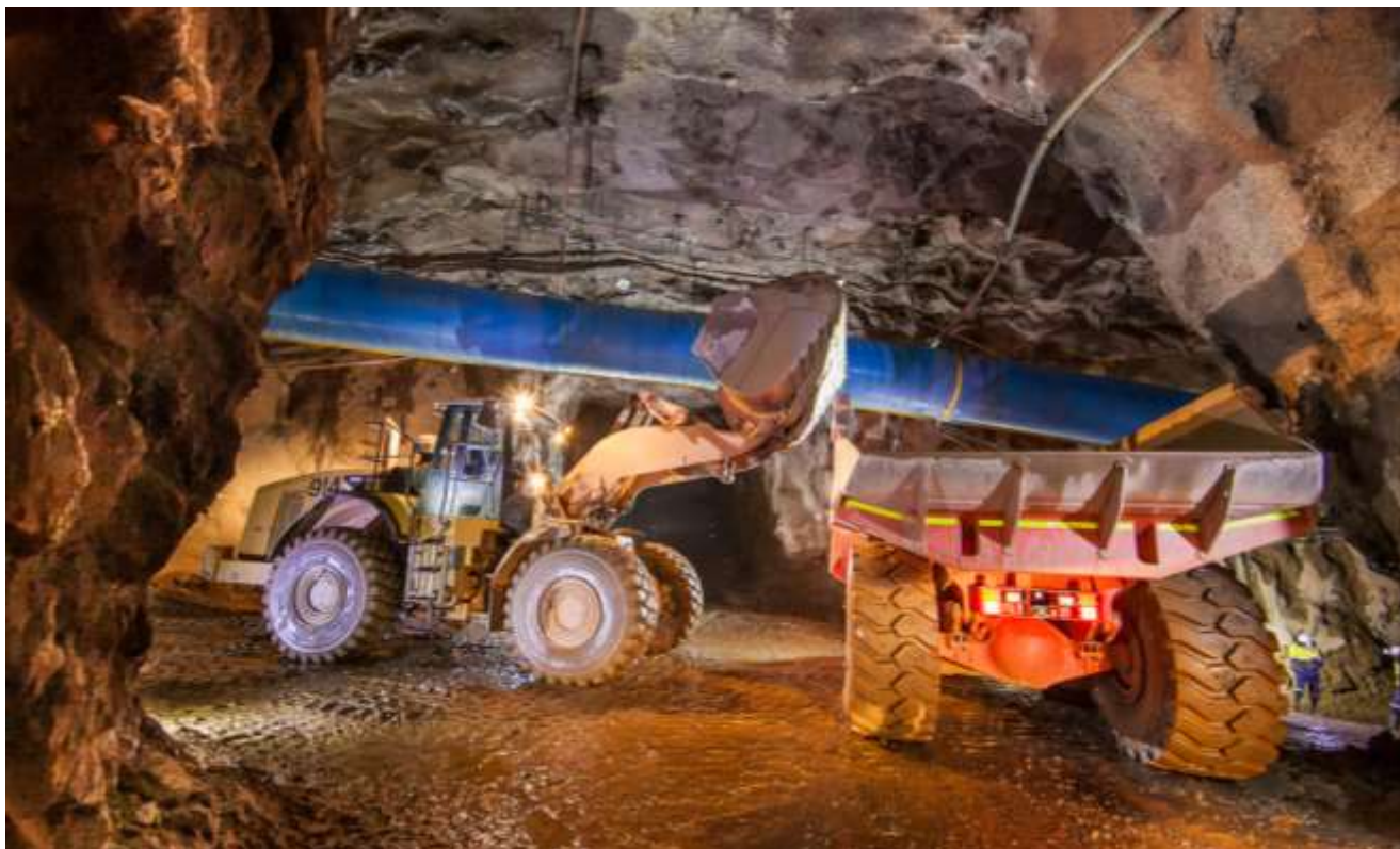
图 8：在 Kamoa-Kakula 铜矿项目的高品位 Kansoko 矿建设斜坡道。
